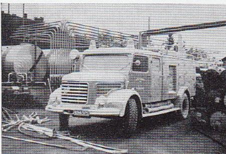
„ULF“ mit 750 kg Pulver-Löschanlage
